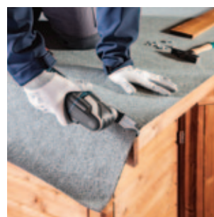
Řezání měkkých materiálů, např. střešní lepenka, linoleum, karton, koberec
