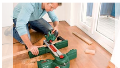
Nastavitelný svislý pokosový úhel od -45^\circ do +45^\circ .
