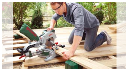
Flexibilní boční prodlužovací díly pro pohodlné řezání dlouhých obrobků.
